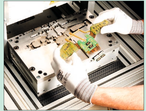
In der Werkzeugform erhält das Produkt seinen stützenden und formgebenden Verguss.
