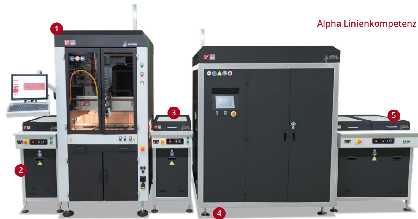
Alpha UV-Cure Inline UV-Aushärtungssystem für sekundenschnelle Stabilisierung
